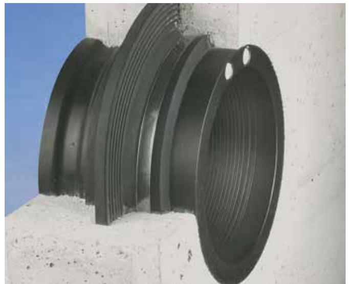
A tomada de conexão SAM é montada rente à cofragem e preenchida com betão. A ranhura prefabricada permite uma fixação segura, o anel de drenagem para alvenaria fornece a vedação.
